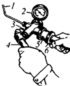
1 - топливопровод; 2 - манометр; 3 - насос; 4 - рычаг насоса; 5 - корпус; 6 - рукоятка
